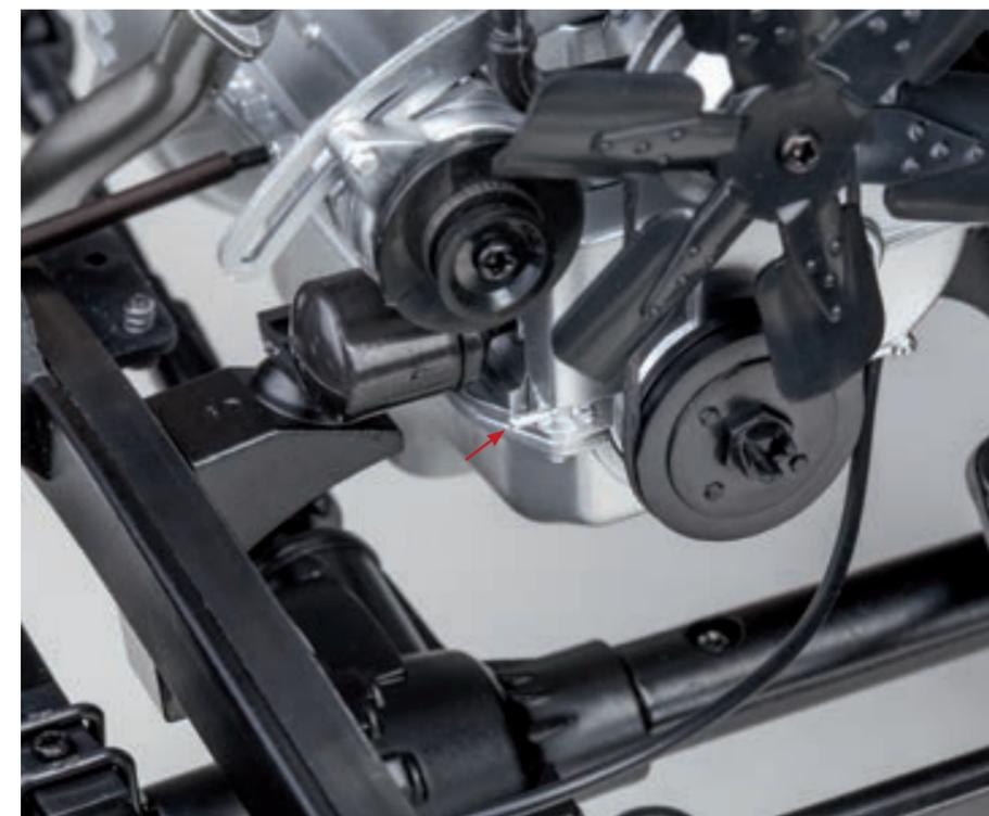
**Шаг 8.** Аналогичным образом закрепите более короткий нижний шланг масляного радиатора на штуцере возле масляного фильтра двигателя. Поверх шланга установите защиту нижнего шланга.
