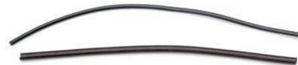
**Шаг 6.** Для корректного монтажа шлангов масляного радиатора определите, какой шланг нижний, а какой верхний: нижний должен быть короче, а верхний длиннее. Аналогичным образом определите и защитные трубки обоих шлангов масляного радиатора.
