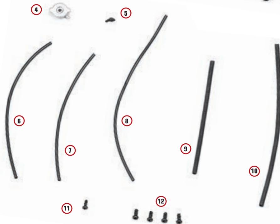
**Шаг 2.** Подсоедините переливную трубку радиатора длиной 80 мм к крепежному штырю пробки радиатора.
