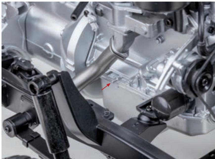
**Шаг 7.** Установите более длинный верхний шланг на штуцер, расположенный в задней части блока двигателя под выпускным коллектором. Для наглядности на фото демонтирован предпусковой подогреватель (для монтажа трубки снимать его не нужно). Поверх трубки разместите защиту верхнего шланга масляного радиатора.
